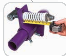
Быстромонтируемый натяжитель позволяет визуально проверять натяжение лезвия
