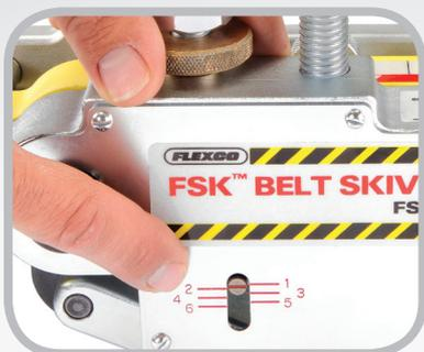
*Простота выбора и настройки глубины снимаемого слоя.*
