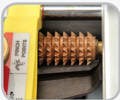
*Передние приводные ролики жестко захватывают снимаемый слой ленты в начале прохода для предотвращения проскальзывания ленты.*
