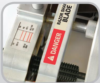
*Устройство FSK™ доступно на выбор с металлическим или пластмассовым гребнем для регулировки ширины снимаемого слоя. Металлический гребень идеален для условий, где требуется повторяемая ширина снятого слоя.*
